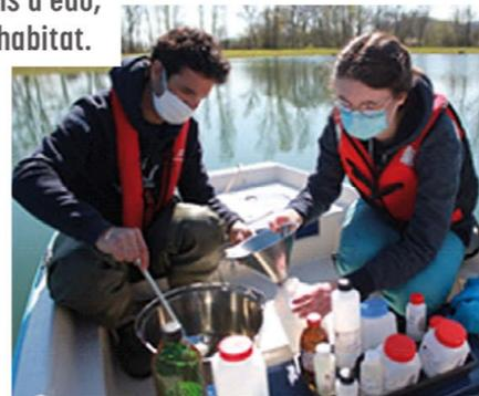
Remplissage des flacons pour les analyses d'eau
